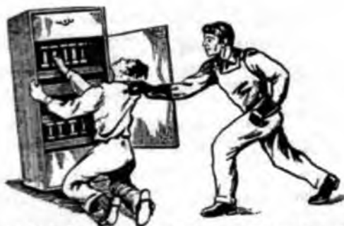
Рис. 4. Освобождение пострадавшего от токоведущей части электрического тока
