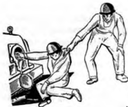
Рис. 3. Освобождение пострадавшего от действия электрического тока путем отключения пострадавшего от токоведущей части, находящейся под напряжением до 1000 В
